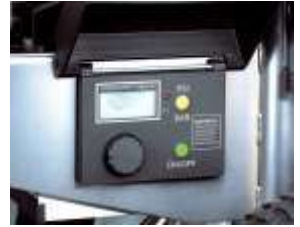
Çabuk tepkimeli elektronik LCD ekranlı basınç ayarı (BAR veya PSI seçeneği)
